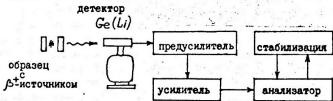
Рис. 10. Блок-схема ПД-спектрометра для измерения доплеровского уширения аннигиляционной линии 0,511 МэВ
